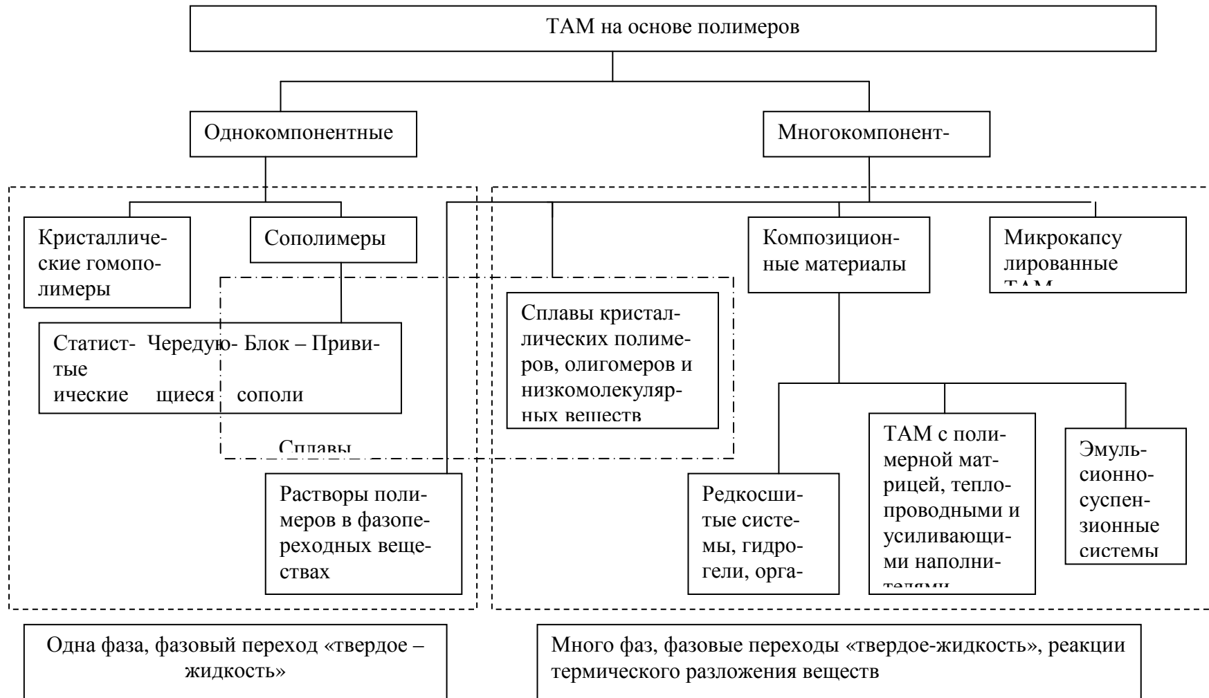
СХЕМА 4 – Классификация теплоаккумулирующих материалов , содержащих высокомолекулярные соединения
